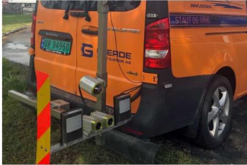
Etat 4 Kontrollerer rekkverk på rekordtid
